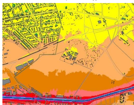
Vasúti zajterhelés éjjel
